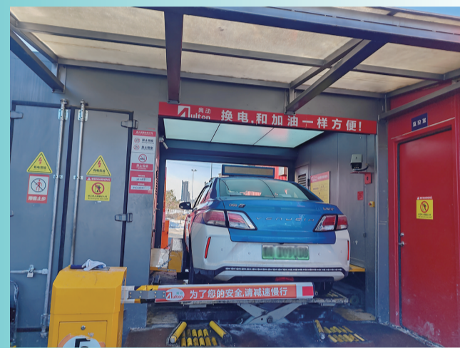
正在进行换电的新能源出租车
