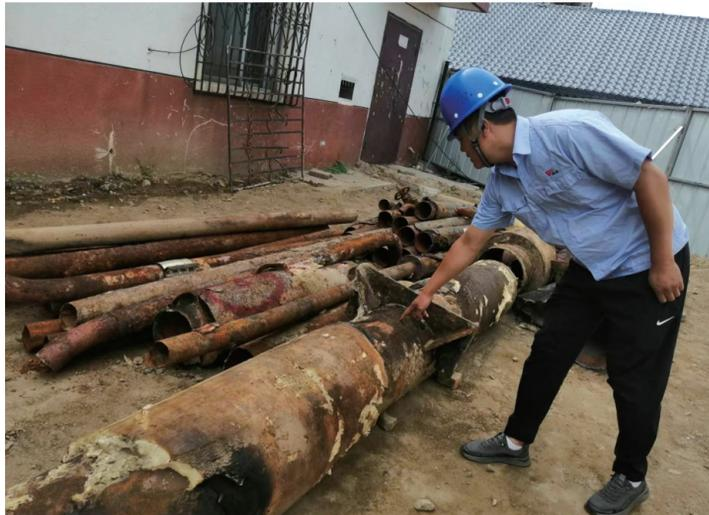
拆下的供热旧管道老化严重，锈迹斑斑
