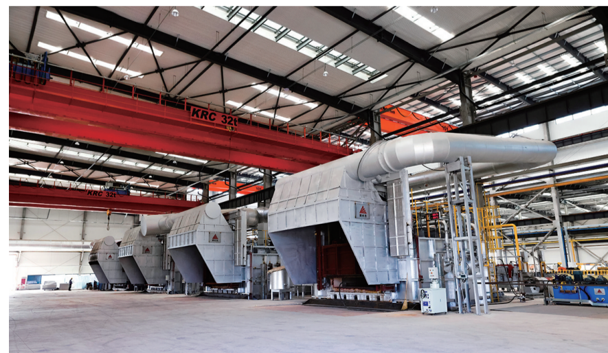
呼和浩特超今新材料有限公司生产车间内的倾翻式熔保护炉
