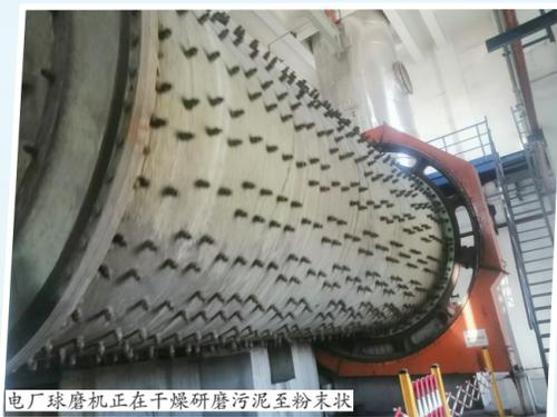
电厂球磨机正在干燥研磨污泥至粉末状
