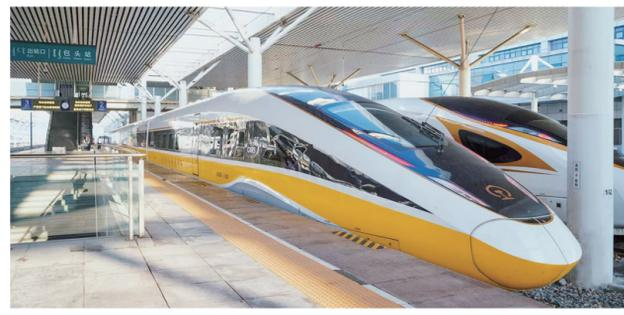
本报讯(记者安娜)8月3日,55601次CR400BF-J-0001型复兴号综合检测列车从包头站驶出,开始对包银高铁包惠段各系统设备设施性能进行综合检测,为线路开通运营做准备。
