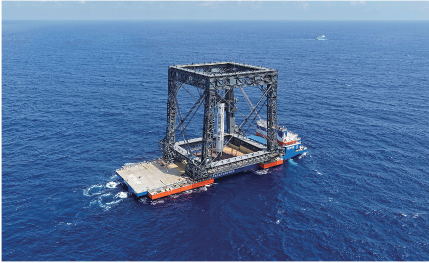
这是海上回收平台通过网系捕获方式成功回收长征十号乙运载火箭一级级（7月10日摄，无人机照片）。 ■新华社记者 邢广利 摄
