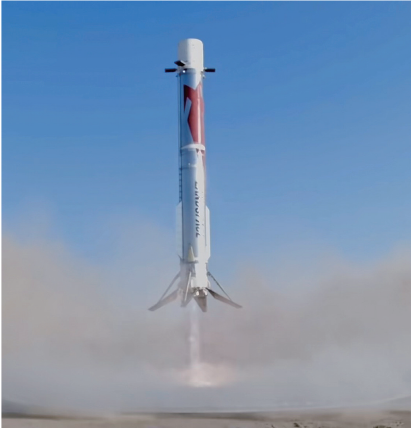
8月19日,视频截图显示朱雀三号遥二运载火箭一子级在着陆过程中展开着陆支腿,正在着陆。 ■新华社发(蓝箭航天供图)
