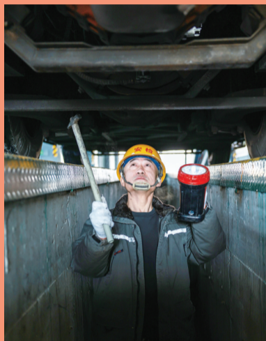
工作人员对每一辆发出的车辆进行检查
