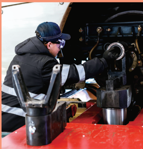
动车机械师进行车轮车床轴端压爪对位压紧作业
