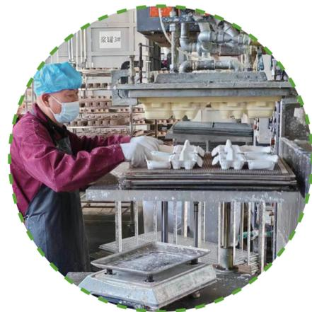
内蒙古必硕环保科技有限公司生产线工人正在将纸浆模具进行塑形、烘干、打磨。
