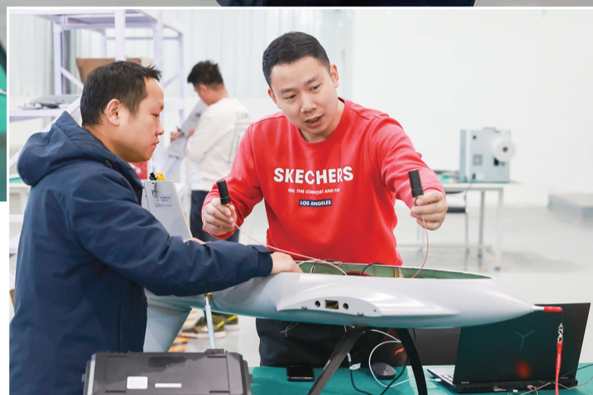
呼和浩特市现代信息技术学校校长助理夏季(右一)指导技术人员调试LY-29联接翼垂直起降无人机
