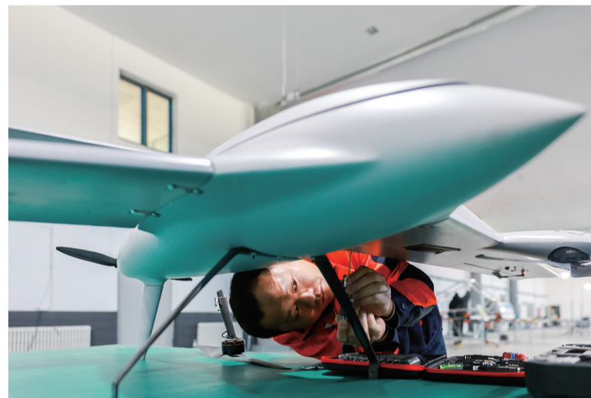
技术人员对无人机腹部构件进行检查
