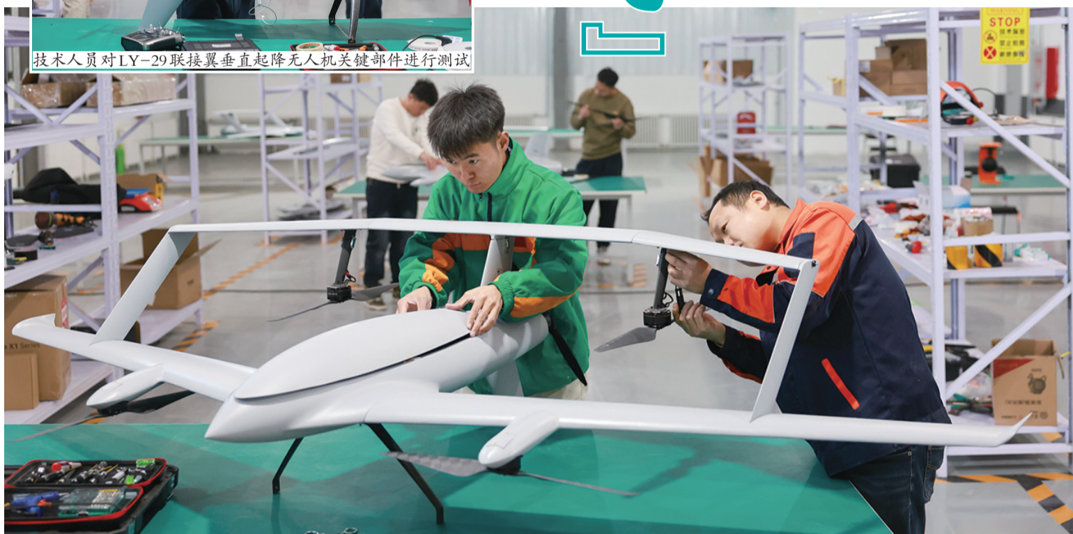
技术人员正在组装LY-29联接翼垂直起降无人机
