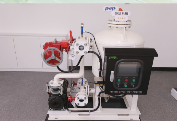
内蒙古璇玑创展科技有限公司实训中心展出的旁滤系统
