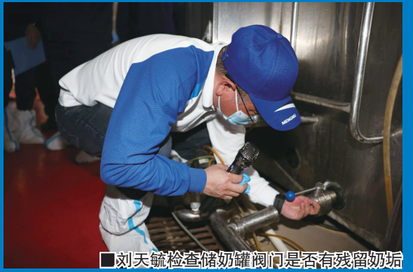
■刘天毓检查储奶罐阀门是否有残留奶垢
