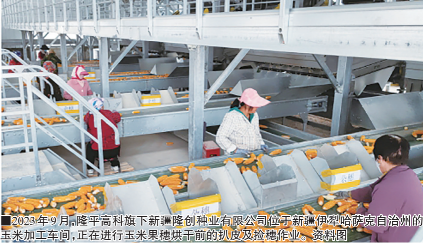
2023年9月,隆平高科旗下新疆隆创种业有限公司位于新疆伊犁哈萨克自治州的玉米加工车间,正在进行玉米果穗烘干前的扒皮及捡穗作业。资料图
