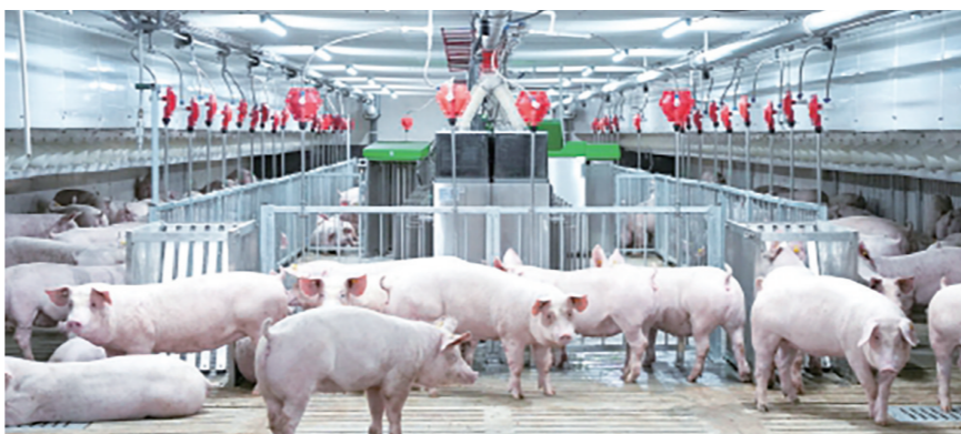
■肉猪分栏群喂系统可实现肉猪智能分区、精准出栏预估、异常标记。资料图片
