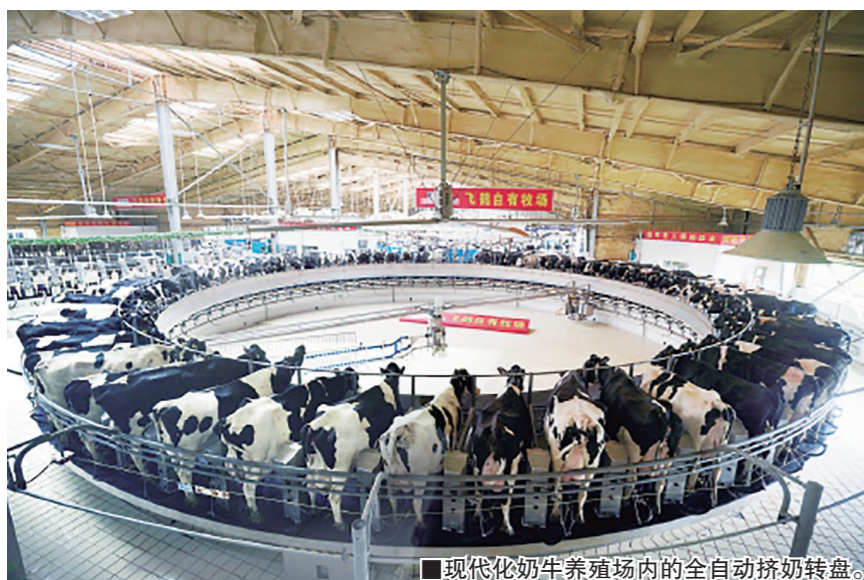
■现代化奶牛养殖场的全自动挤奶转盘。
