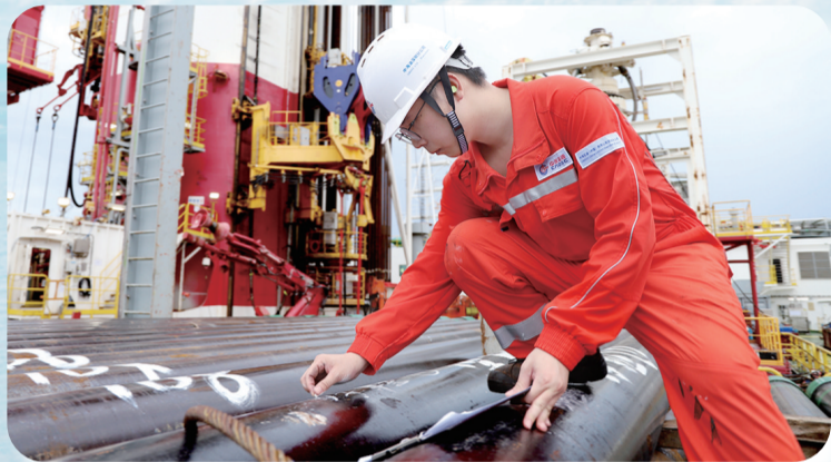
作业人员在开平南油田“深蓝探索”钻井平台上测量套管
