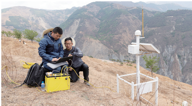
中国科学院成都山地灾害与环境研究所公共技术中心主任、高级工程师李战鲁(左)和东川站副站长、高级工程师钟卫,在讨论使用高密度电法仪探测蒋家沟斜坡地层及坡体结构特征。
